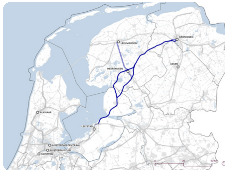
Figuur 3.2 Bundelingsalternatief met varianten bij Heerenveen en Groningen (blauwe lijn is nieuw spoor, blauwe dubbele lijn is bestaand spoor)
