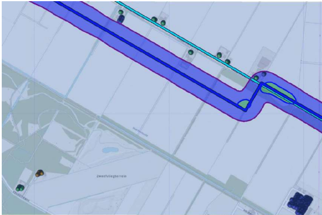
Figuur 4.2 Plaatsgebonden risico voor 6975_leiding-N-500-48-deel-1 excl. verl. (groene gebied = alles binnen PR 10^{-7} contour, blauwe gebied = alles binnen PR 10^{-8} contour)
