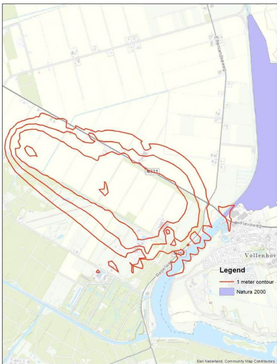
Figuur 3. Geluidscontouren van de 51, 45 en 42 dB(A) (rode lijnen) van het geluid op 1 meter hoog, waarbij de binnenste lijn de 51 dB- en de buitenste lijn de 42 dB-contour weergeeft tijdens de gebruiksfase van het testcircuit (bron geluidscontouren: dgmr; bron kaartondergrond: Esri Nederland, Community Map Contributors).
