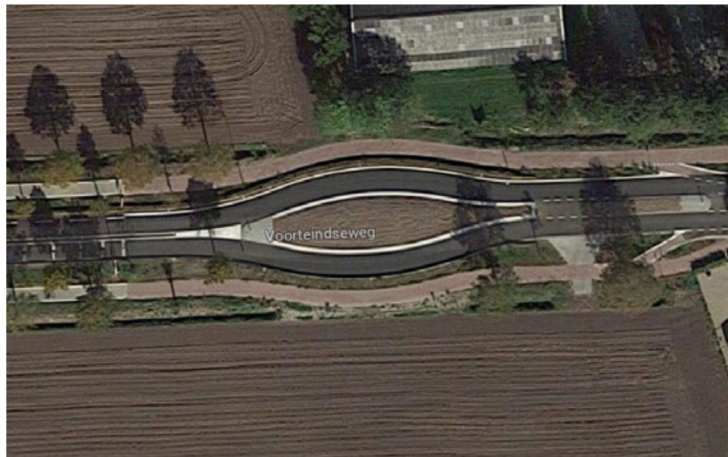
Afbeelding 15: Bovenaanzicht schuin uitbuigende middengeleider.
