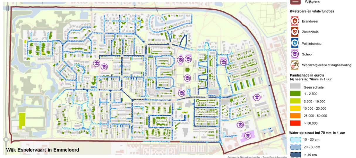
Schade aan panden door wateroverlast en water op straat bij een bui van 70mm in 1 uur
